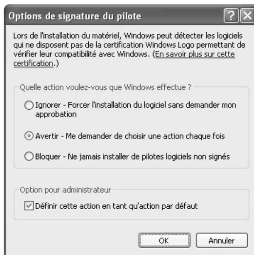
Si [Bloquer] est sélectionné, vous ne pouvez pas installer le pilote d'imprimante. Sélectionnez [Avertir] et installez le pilote d'imprimante.
